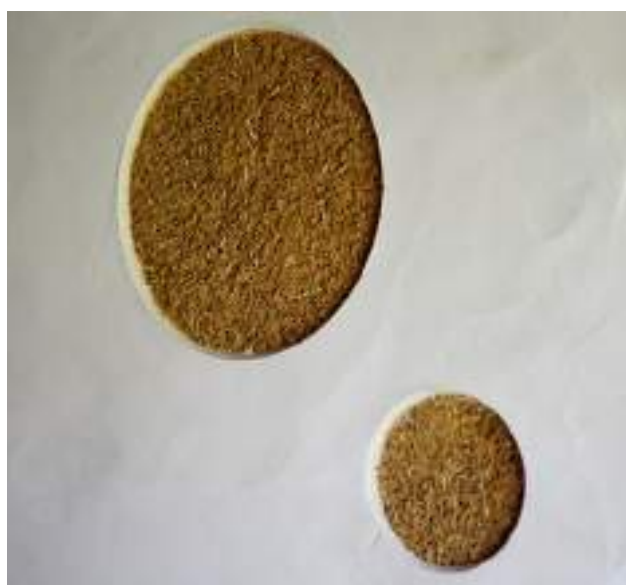
© Chanvriers en Circuits Courts – Enduit chanvre
